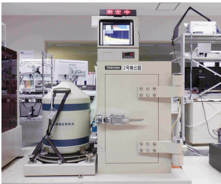
セシウム137などを測定するゲルマニウム半導体検出器付核種分析装置
