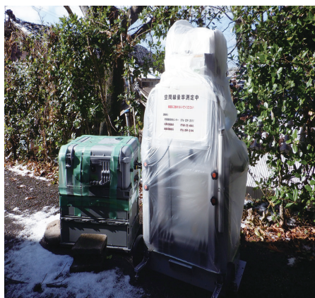
衛星回線付可搬型モニタリングポスト
