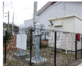
環境放射線観測局 (能登島局：七尾市(地図下線)) 空間放射線や風向、風速などを測定しています。
